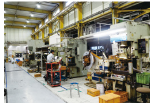
プレス加工の現場。金属板をプレス加工後、研磨や塗装などが施される
